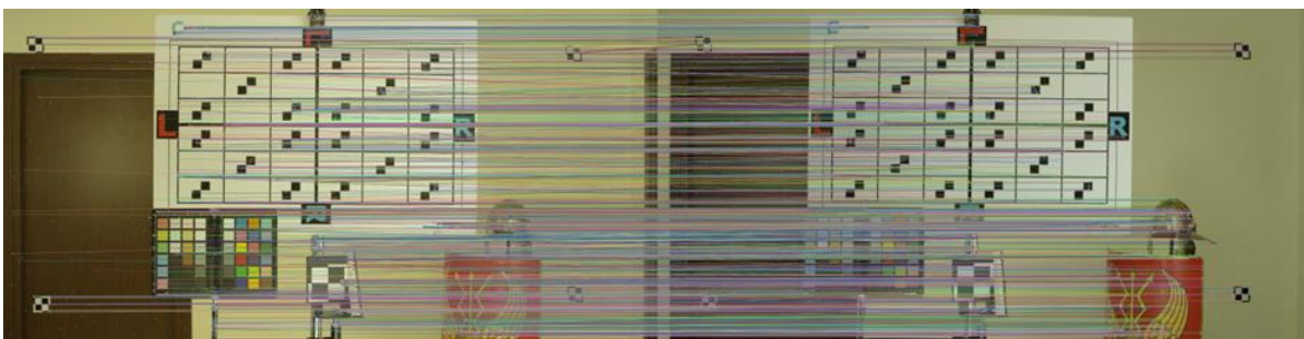
Rys. Korelacja stereopary uzyskana za pomocą procesu dopasowywania wzorców cech oraz mechanizmu okna przesuwającego z zastosowaniem zestawu algorytmów ORB, BRISK, Brute-Force-Hamming oraz filtrowania symetrycznego.
